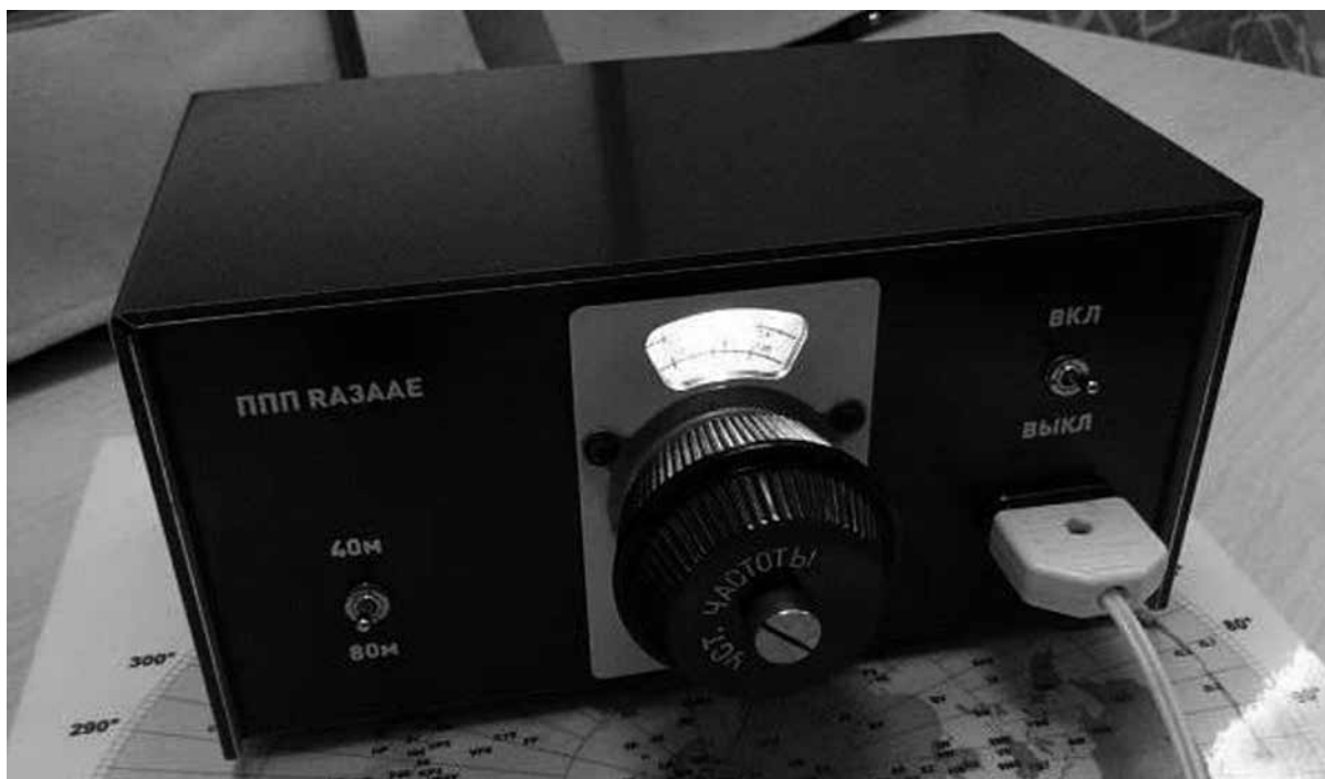
Рис. 2.8. Приёмник прямого преобразования В.Т. Полякова (РА3ААЕ) на 40 и 80 м.
