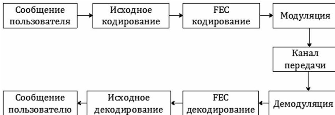
Рис. 9.4. Блок-схема информационных потоков в системе цифровой связи
