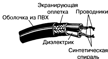
Рис. 5.11. Экранированная двухпроводная линия
