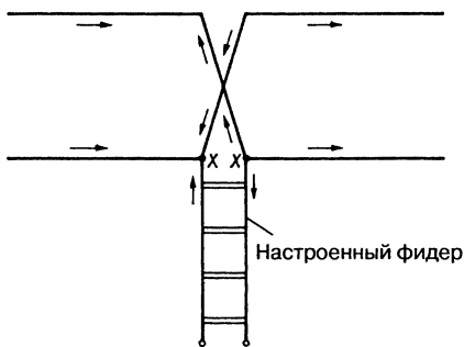
Рис. 13.13. Синфазная горизонтальная антенна с настроенным фидером
