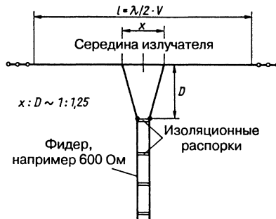
Рис. 6.1. Согласующий дельта-трансформатор
