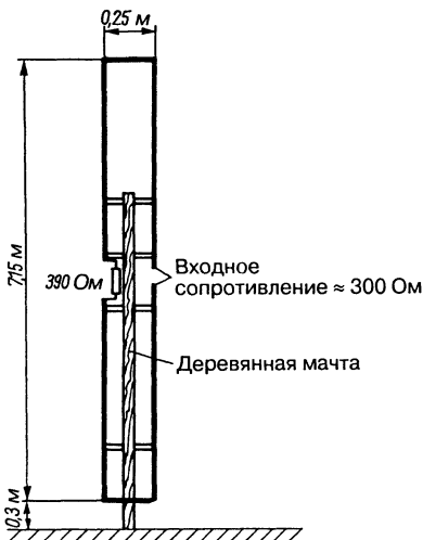
Рис 19.67 Многодиапазонная вертикальная антенна по принципу T2FD
