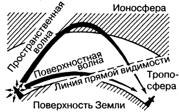
Рис. 2.3. Пути распространения поверхностной и пространственной электромагнитных волн
