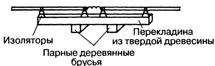
Рис. 18.13. Вариант крепления элементов антенны G4ZU
