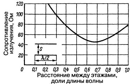
Рис. 13.7. Сопротивление излучения в пучности тока каждого из двух синфазно возбуждаемых параллельных вибраторов в зависимости от межэтажного промежутка S
