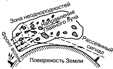
Рис. 2.11. Рассеяние высокочастотных волн в тропосфере
