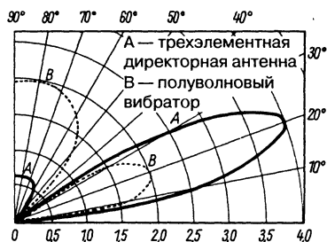
Рис. 3.13. Вертикальная диаграмма горизонтальной трехэлементной директорной антенны и горизонтального полуволнового вибратора на высоте 3/4 \lambda от идеального грунта
